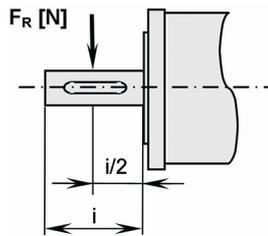
Kraftangriffspunkt Radialkraft: Mitte Abtriebswelle
