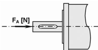
Maximal zulässige Axialkraft gilt nur für Druckbelastung
