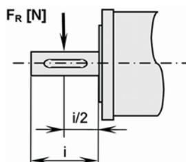
Kraftangriffspunkt Radialkraft: Mitte Abtriebswelle
