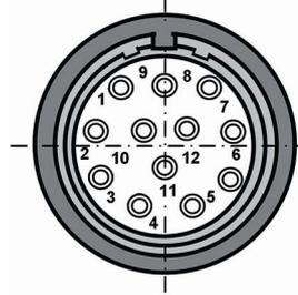
Geberanschluss: 12-pol. Anschlussdose mit Kontaktstiften (Ø 1 mm).
