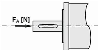
Maximal zulässige Axialkraft gilt nur für Druckbelastung
