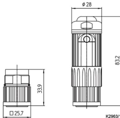
Motoranschluss: 8-pol. Anschlussdose mit Kontaktstiften
