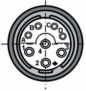
Motoranschluss: 8-pol. Anschlussdose mit Kontaktstiften (1...4 Ø 2 mm, A...D Ø 1 mm).
